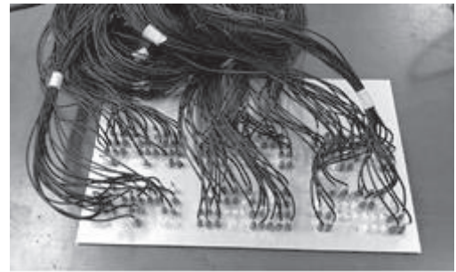
図 11 グルーガンで固定したテストピンジャック
