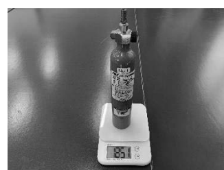
図 7 水素充填後に計測した水素吸蔵合金ポンベ No.1
