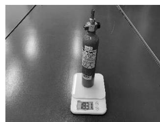
図 6 全放出状態で計測した水素吸蔵合金ポンベ No.2
