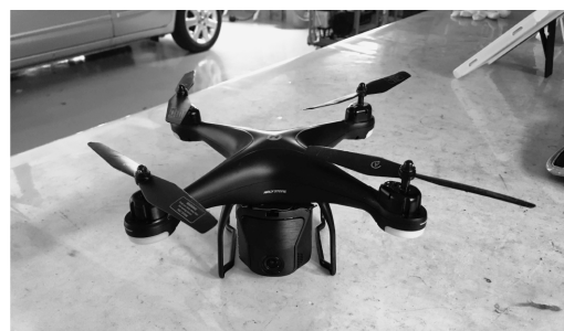
図 3 ドローンにドライブレコーダーを搭載した外観
