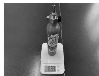
図 5 全放出状態で計測した水素吸蔵合金ポンベ No.1
