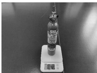
図8 水素充填後に計測した水素吸蔵合金ポンペ No.2
