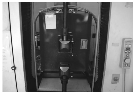
図 5 インストロン型万能試験機
