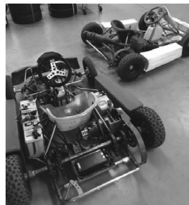
図 5 エンジン・電動ダートレーシングカート
