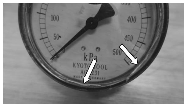
写真 3 ケースのひび割れ個所
