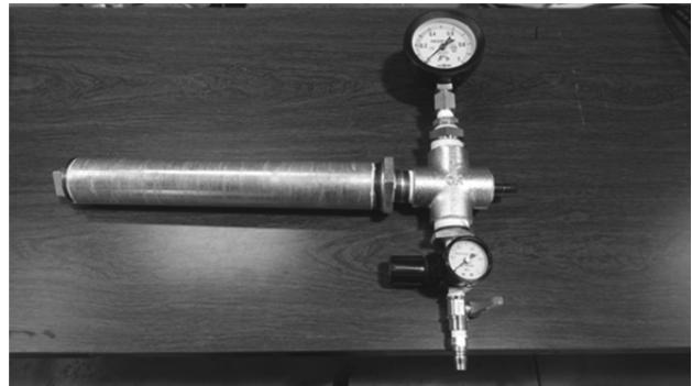
写真 1 タイヤゲージ校正装置試作機
