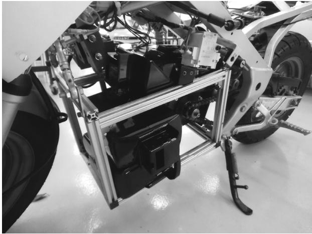
Fig.3 リチウムイオン電池を搭載した状態
