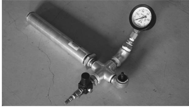
写真4 タイヤゲージ校正装置試作改良機
