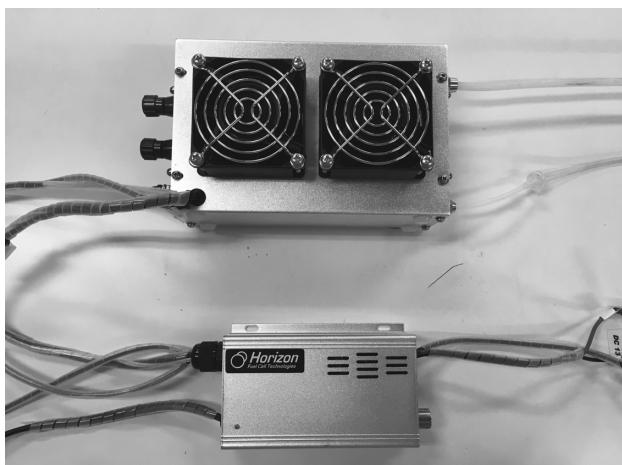
Fig.1 H-B200 PEM 燃料電池システム
