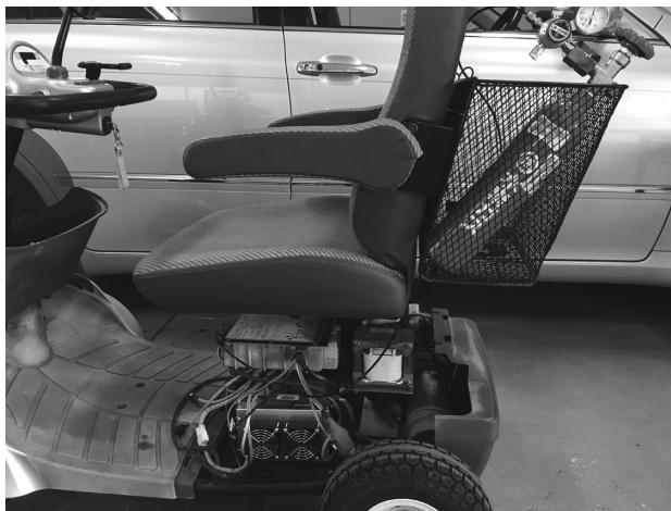
Fig.3 燃料電池と水素ガスボンベを取り付けた状態
