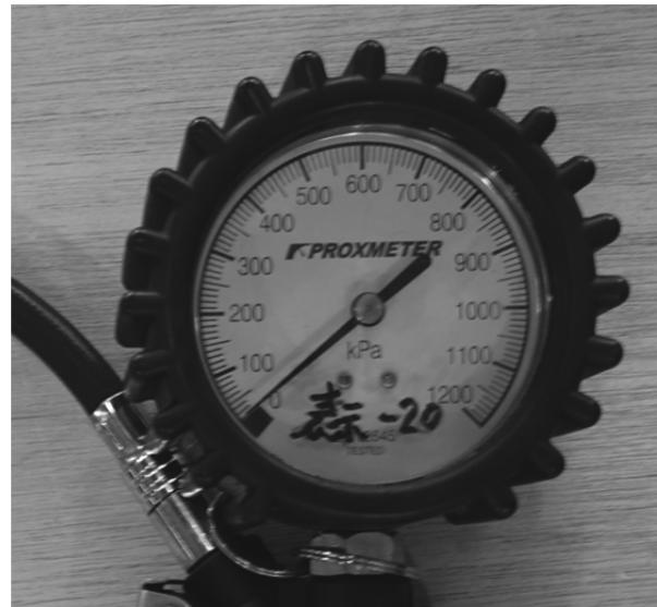
写真 2 補正值を表示したタイヤゲージ
